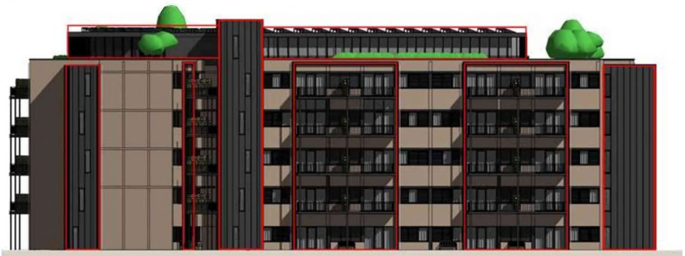
Figuur 6 Huidig ontwerp met in rood de aan te passen geveldelen en geclusterde balkons.
