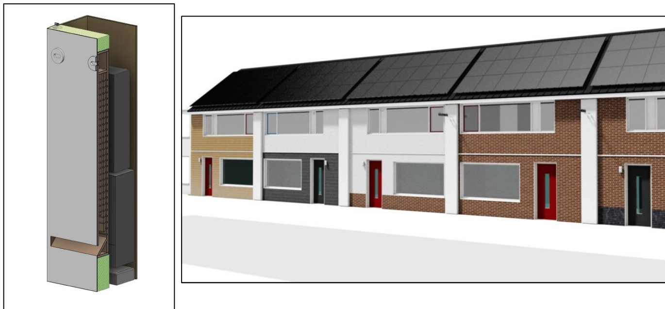
Afbeelding 10: Globale indruk van een detailopname vleermuisverblijf (links) en toepassing ervan op elke woning (rechts) (bron: VolkerWessels).
