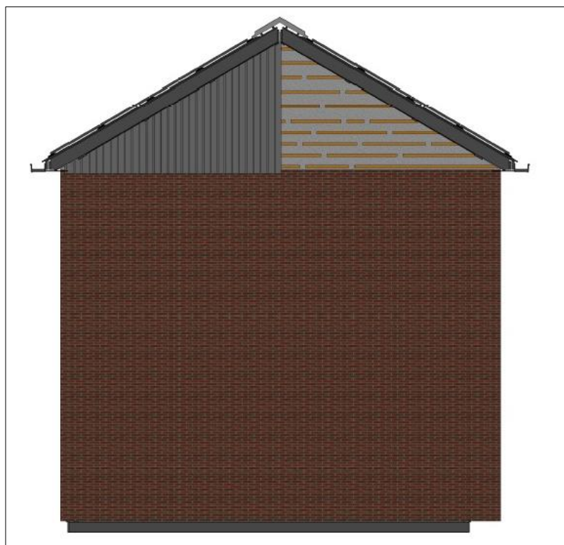
Afbeelding 9: aanzicht van de kopgevel met toegankelijke gevelbetimmering (bron: bam).
