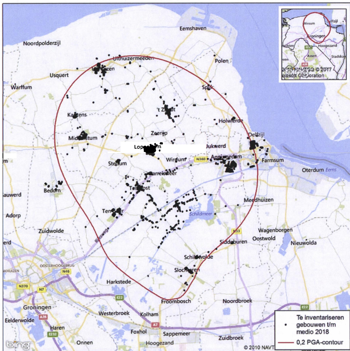
Overzichtkaart plangebied bouwkundig versterken met de 0,2 PGA-contour en de gebouwen die geïnventariseerd zijn vanwege bouwkundige versterking tussen 1 oktober 2017 en medio 2018
