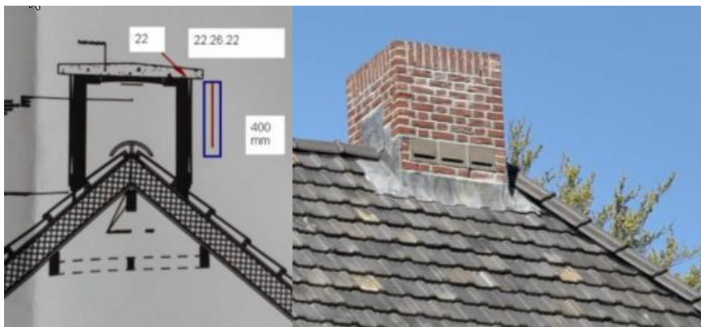
Afbeelding 26: Voorbeeld toegankelijk ruimten in schoorsteen (bron mitigatiecatalogus)
